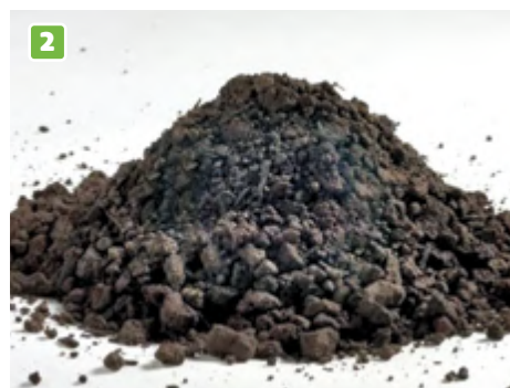
EXTENSIVSUBSTRAT E Dient als Vegetationstragschicht für Extensivbegrünungen
