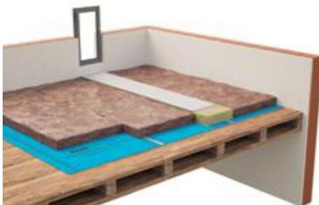
Links die begehbare Dachboden-Dämmplatte TPD-L in Kombination mit Fertigteil-Estrich. Rechts die Dämmrolle Classic mit einem Laufweg aus der druckfesten Materialkombination, wenn Teile des Dachbodens begehrbar sein sollen
