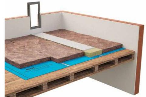
Beim Dachboden mit Laufwegen werden Inseln mit druckfesten Dämmplatten und stabilen Auflagen geschaffen. Der Rest wird mit flexibler, nicht begehbare Dämmung ausgelegt.
