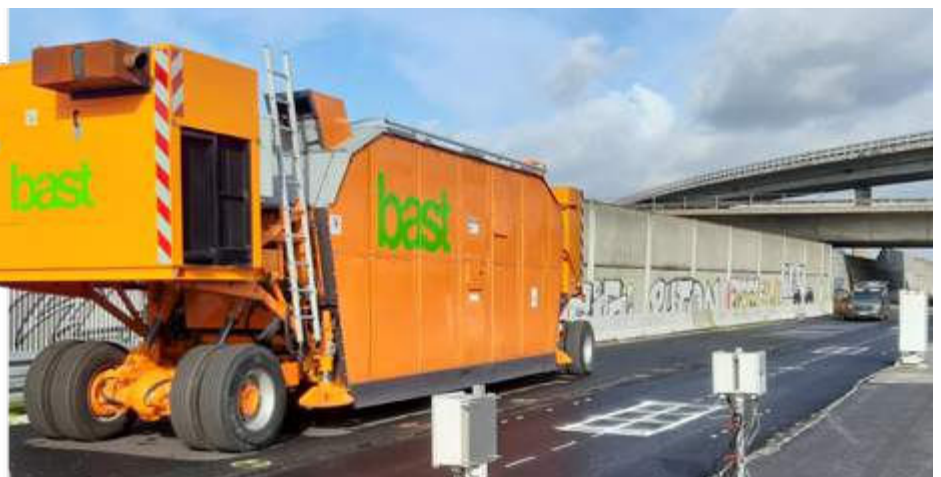
Der MLS30 simuliert die Belastung durch Schwerverkehr im Zeitraffer
